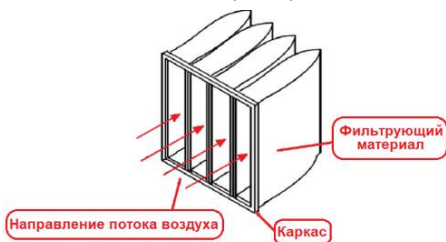
Рисунок 24 (в) Схема устройства карманного фильтра
